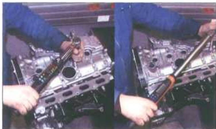
Le serrage dynamométrique angulaire est devenu fiable grâce aux clés électroniques.
