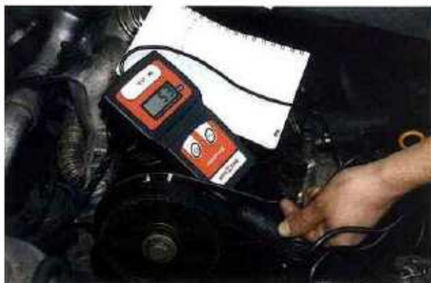
Mise en position du capteur, perpendiculaire à l'avancement de la courroie et parallèlement à la surface supérieure.
