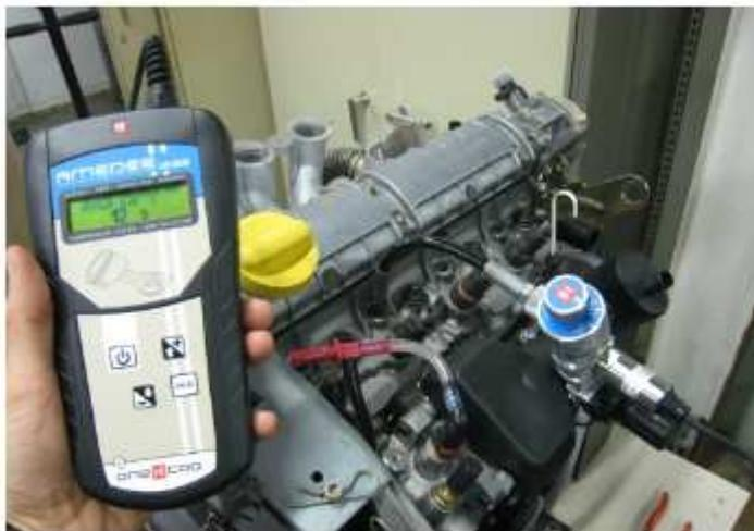
Ainsi, Amédée, seul outil capable de caractériser l'état des hauts de cylindres et qui a su convaincre les garagistes par sa facilité d'utilisation et sa multifonctionnalité, vient d'être homologué par Renault. Amédée mesure les pressions maximales de compression, avec les caractéristiques suivantes :
