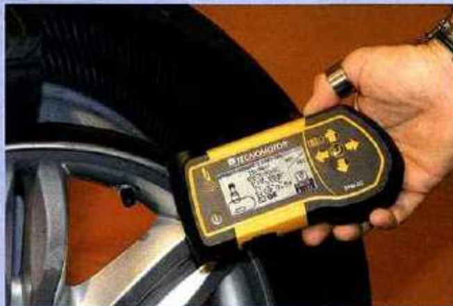
Le boîtier TPM02 est l'assistant complet du pneumaticien, pour le contrôle de fonctionnement et le paramétrage des contrôleurs de pression des pneus.
