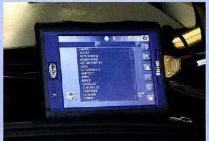
Le Vision distribué par Clas est un "diag" classique, dans un boîtier tactile connecté à l'E-OBD.
