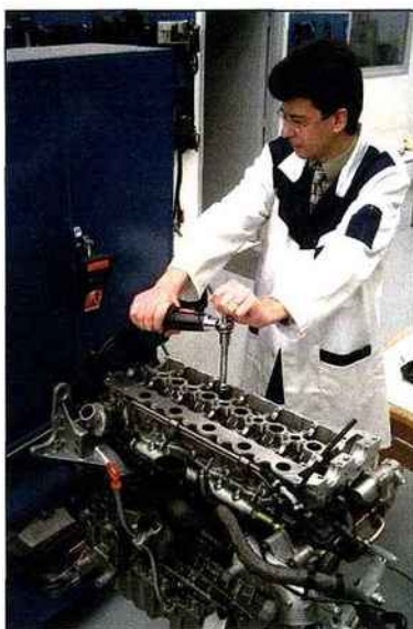
Le serrage dynamométrique idéal, avec une clé numérique, qui réduit l'erreur à moins de 4 % [One-Too]Moment Alpha).
