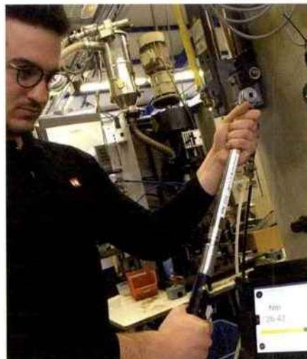
L'interface IHM sur tablette permet de visualiser en temps réel les résultats d'un serrage par rapport à la stratégie programmée. Elle permet d'enregistrer les données pour une analyse fiable et une traçabilité optimale.
